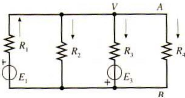
dobbiamo trovare la Resistenza e il Generatore equivalente. Due resistenze si dicono in serie se sono attraversate dalla stessa corrente, mentre si dicono in parallelo se sono sottoposte alla stessa tensione. Per ottenere la Req. di due resistenze in serie basta una semplice somma mentre per la Req. di due resistori in parallelo si usa la formula :
