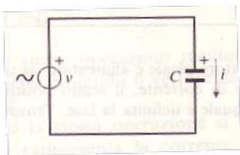
La capacità  $C$  si misura in [farad]
